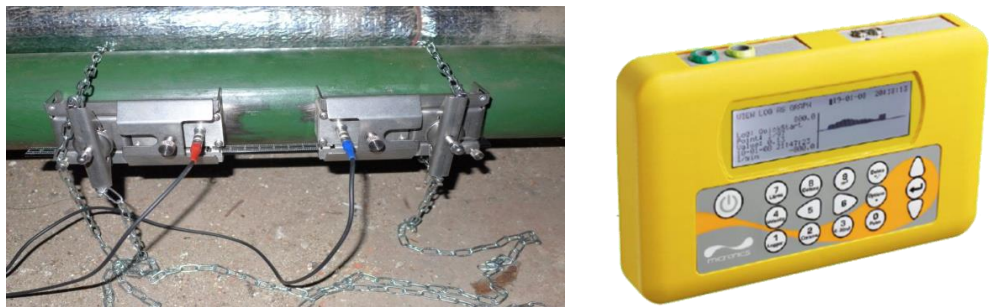
Рис. 3. Установка датчиков ультразвукового расходомера
