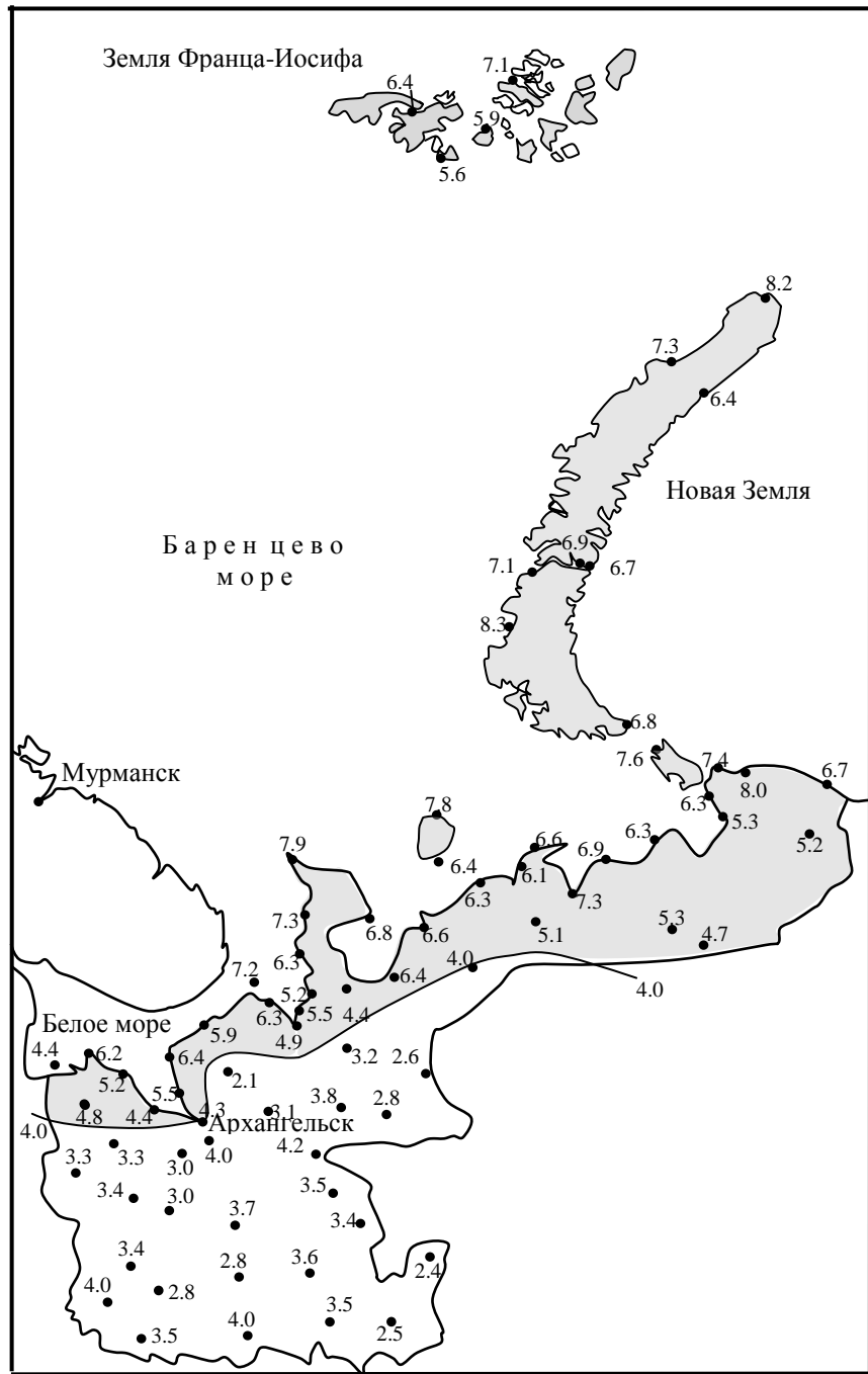
Рис. 2. Средние многолетние скорости ветра на метеостанциях Архангельской области на высоте 10 м от поверхности земли
